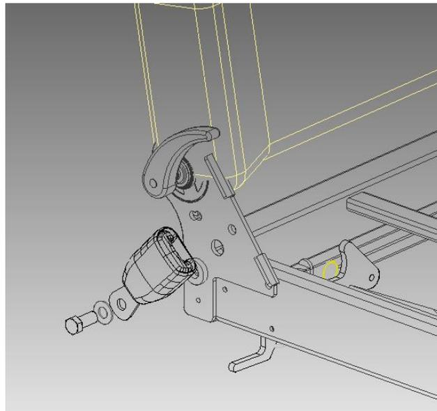
*Installation du bloc d'arrêt***Étape 13 SAUTER CETTE ÉTAPE SI LE DOIGT D'INDEXAGE N'EST PAS COURBÉ**
